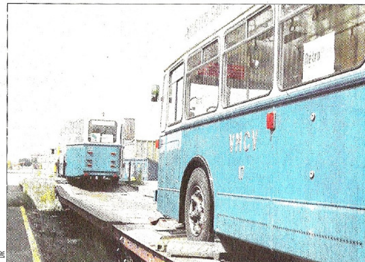
Le trolley N°17 et sa remorque en gare de Renens, sur un wagon surbaissé, adapté au transport de véhicules de grande taille. Il aura fallu une journée de travail pour l'en faire descendre.
